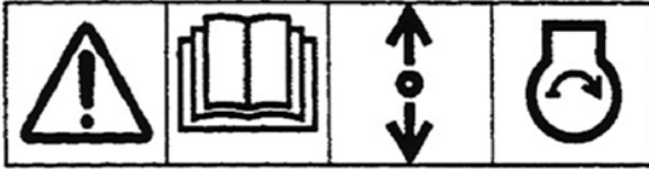
Kuva 1. Varoituskilpi moottorin käynnistämisestä vain vapaalla
